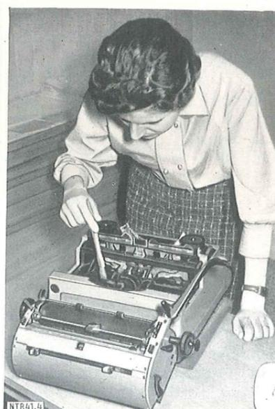
Bild 4. Stenotypistin beim Reinigen der Maschine (Wagen abgenommen)
