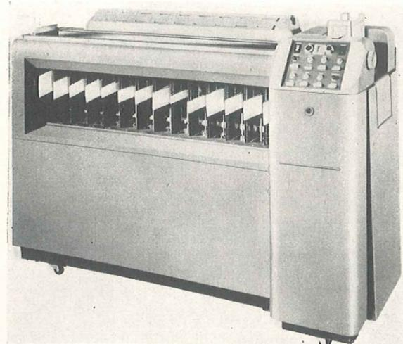
Bild 8. Elektronische Sortiermaschine Remington-Rand, 48000 Karten pro Stunde
