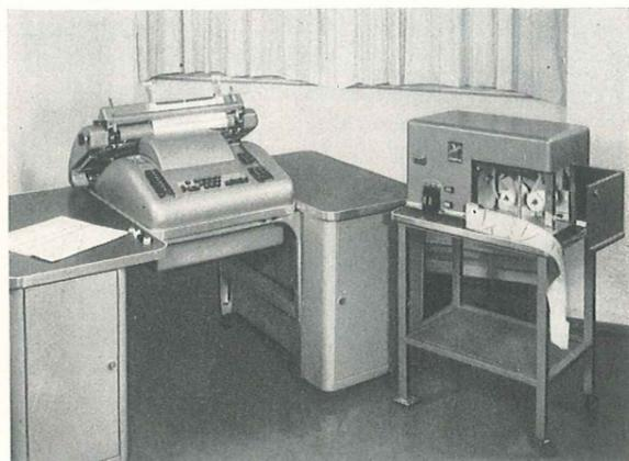
Bild 5. Buchungsautomat Exacta 6000 mit angeschlossenem Bull-Lochband-Stanzer (20er Kanal)
