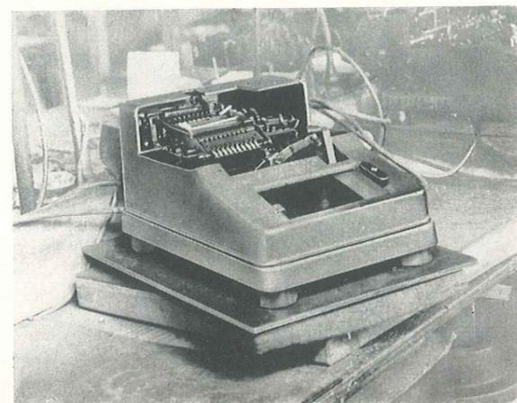
Bild 6. Steuereinrichtung für Speicherwerk der Rheinmetall-Fakturiermaschine
