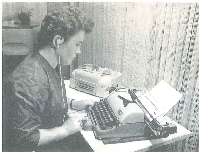
Bild 2. Combina-Kleinschreibmaschine mit Fernbedienungsteil für das Diktiergerät „diktina“
