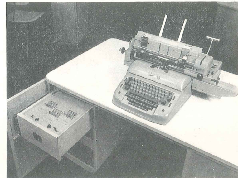
Bild 4. Rheinmetall Fakturiermaschine FMSE III/3 mit halbautomatischer doppelter Einziehvorrichtung. Im linken Schreibtischteil befinden sich die Einstellwerke für die konstanten Multiplikatoren und für das Datum
