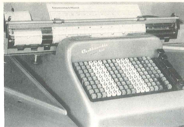
Bild 7. Optimatic-Buchungsautomat Modell 922 mit geteilter Walze (links Additionsrolle, rechts Abteilungskonto)
