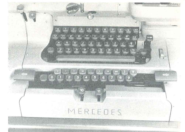
Bild 4. Buchungsmaschine Modell SR 22 (Schreib- und Rechentastatur sowie Einrichtung für englische Währung — 2 zusätzliche Rechentasten —)
