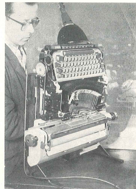
Bild 8. Die elektrische Schreibmaschine in der Endmontage
