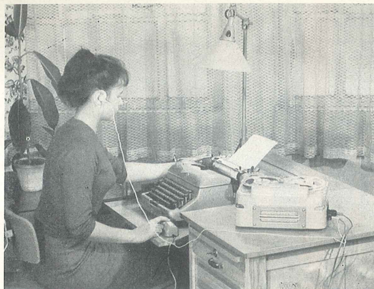
Bild 2. „diktina“ mit Fernbedienungsschalter und Kleinsthörer am Ohrbügel
