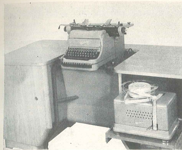
Bild 7. Fakturiermaschine Modell FM mit Lochstreifeneinrichtung
