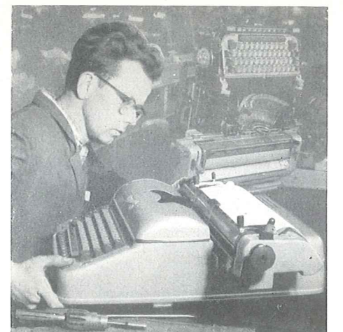
Bild 9. Aufsetzen der Verkleidung als letzte Operation in der Fertig-Montage der GSE
