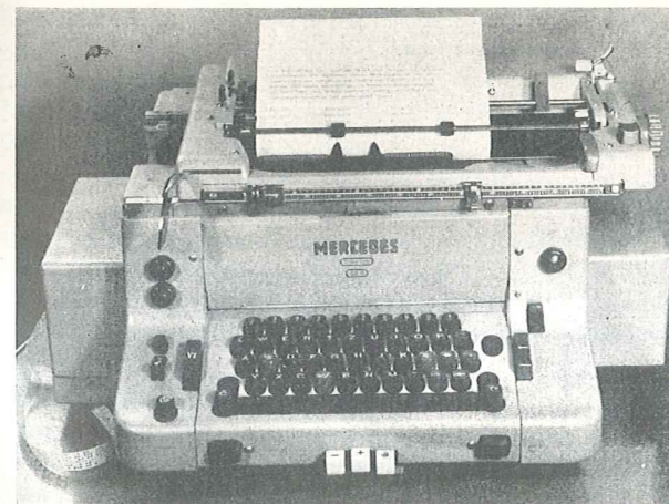
Bild 1. Elektrische Schreibmaschine SE 4 mit Streifenlocher und Steuerschiene
