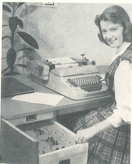
Bild 5. Elektrische Schreibmaschine hochgestellt und Rechenwerk teilweise herausgezogen für eine Durchsicht im Ablauf des Wartungsdienstes
