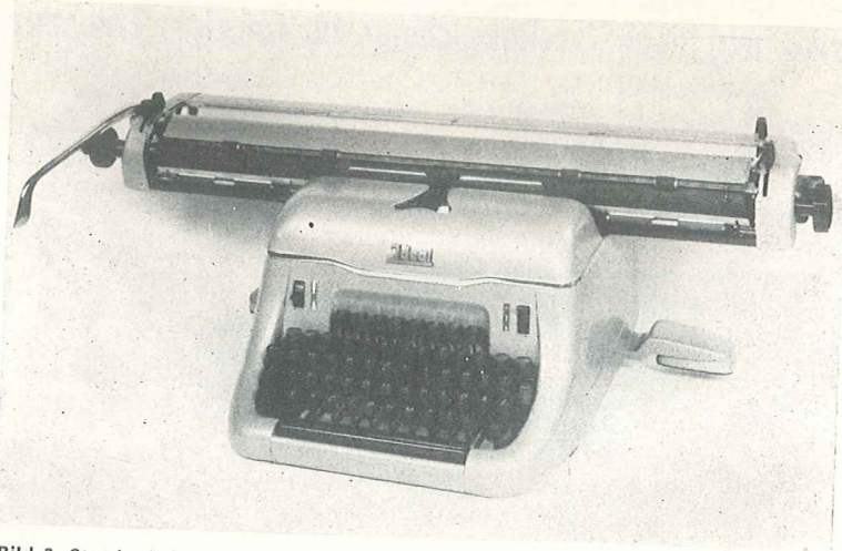
Bild 3. Standardschreibmaschine Ideal mit 62-cm-Wagen
