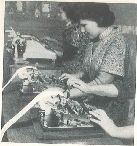
Bild 3. Die Saldiermaschine Typ 160 in der individuellen Schlußkontrolle
