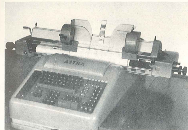
Bild 3. Astra-Registrier-Buchungsautomat Klasse 160 mit automatischer Karteneinzugsvorrichtung
