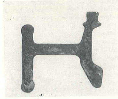
Bild 4b: 3prozentiger Salzsprühnebel nach 144 Stunden allseitig ausgebreitete intensive Verrostung
