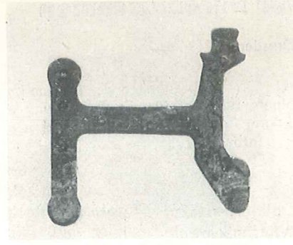
Bild 3b: 3prozentiger Salzsprühnebel nach 144 Stunden allseitig ausgebreitete intensive Verrostung
