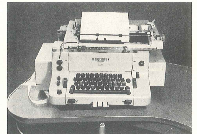
Bild 3. SE 4 mit Streifenlocher (5-Kanal-System) mit Steuerschiene. Tastatur tschechisch (Ausführung für Skodawerke)
