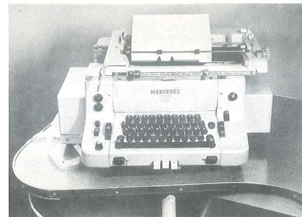
Bild 1. SE 4 mit Lochbandlocher und Steuerschiene (5-Kanalsystem)
