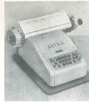
Bild 3 ASTRA-Schnellsoldiermaschine Klasse 112 mit Schüttelwagen
