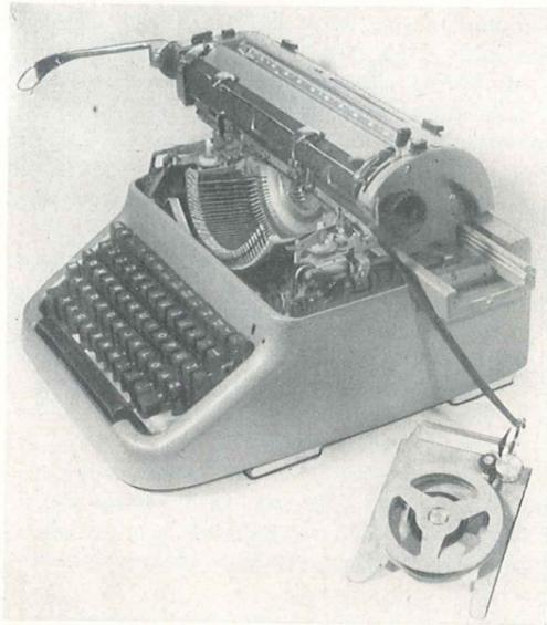
Bild 6. Kassettenschieber für das Kohleband, herausgenommen
