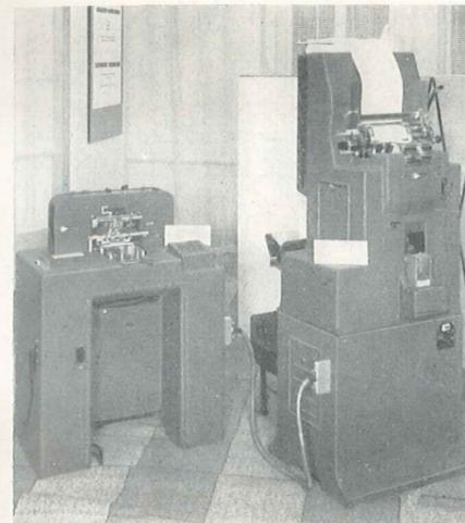
Bild 1. Kombiniertes Motorwiederholungslocher, Prüflocher und Summenstanzer für 21er Tabelliermaschine (ICT)
