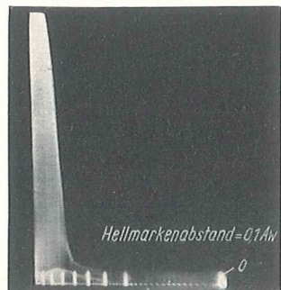
Bild 17. Oszillographisch aufgenommene Hüllkurve eines Hystereseschleifenastes. Kern: 2 mm Valvo (6 D3)
