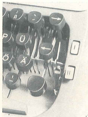
Bild 11. Teilansicht: Einstellung der Ein- und Zweifachschaltung, Einstellhebel für Funktionssperre
