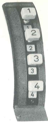
Bild 17 (rechts). Schloßbank vom Modell 68 400 Z mit 4 Steckschlüsseltasten für 4 Addierwerke
