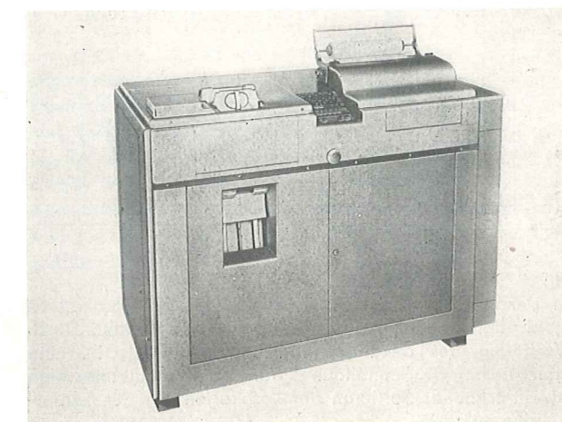
Bild 8. Tabelliermaschine Typ 401 des VEB Büromaschinenwerk Sömmerda
