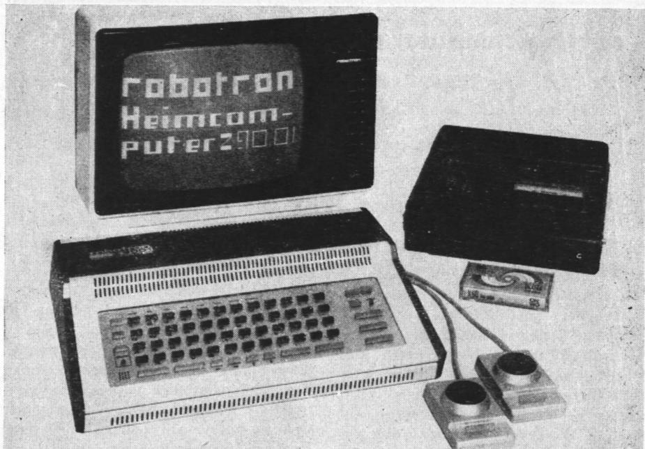
Bild 1. Heimcomputer mit Fernsehgerät und Kassettengerät
