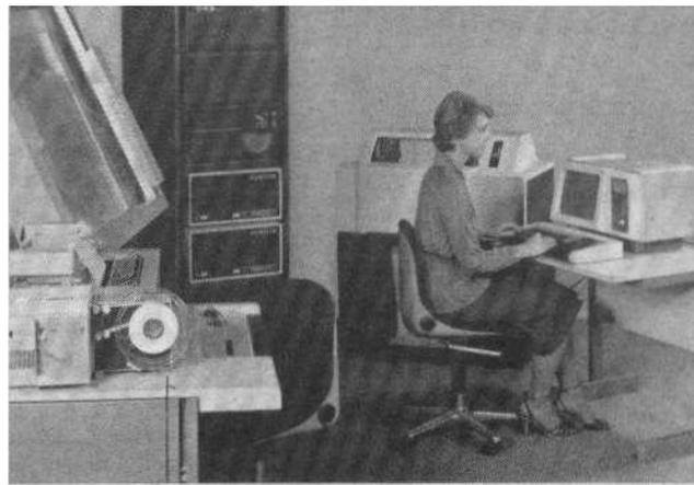
Neben dem im vorigen beschriebenen AKT A 6454 zeigt der abgebildete A 6452 die Vielfalt der arbeitsplatzbezogenen Konfigurationsmöglichkeiten der Basisrechner. Er wurde speziell zur Entwicklung und Konstruktion von Leiterplatten mit rechen technischer Unterstützung geschaffen. Werkfoto
