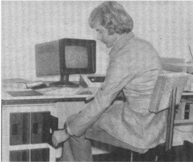
Mikrorechner-Entwicklungssystem robotron A 5601, das sich auch für die Generierung der problemorientierten Systemunterlagen für die Prozeßrechnerysteme A 6491/A 6492 eignet. Werkfoto
