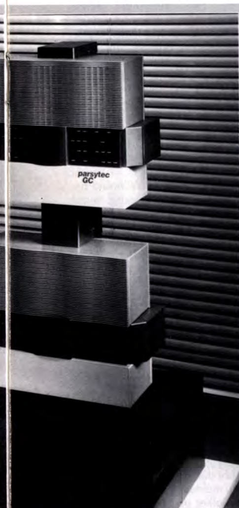
detete GC2 enthält 256 Prozessoren. Erweiterungen werden einfach angesteckt.
