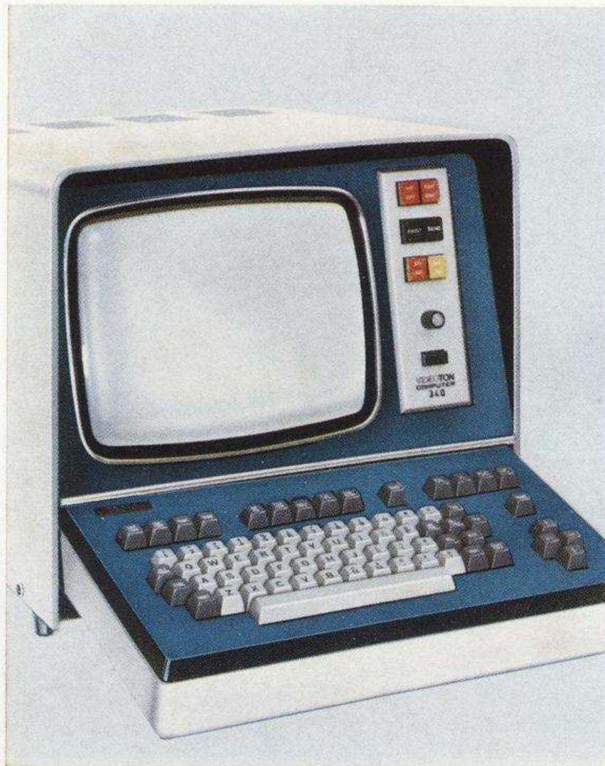
Das Bildschirmgerät VIDEOTON 340 ist eine selbständig arbeitende Einheit, die als Auf-tischgerät ausgeführt ist. Die Tastatur und die Bildschirmeinheit sind getrennte Bau-gruppen.
