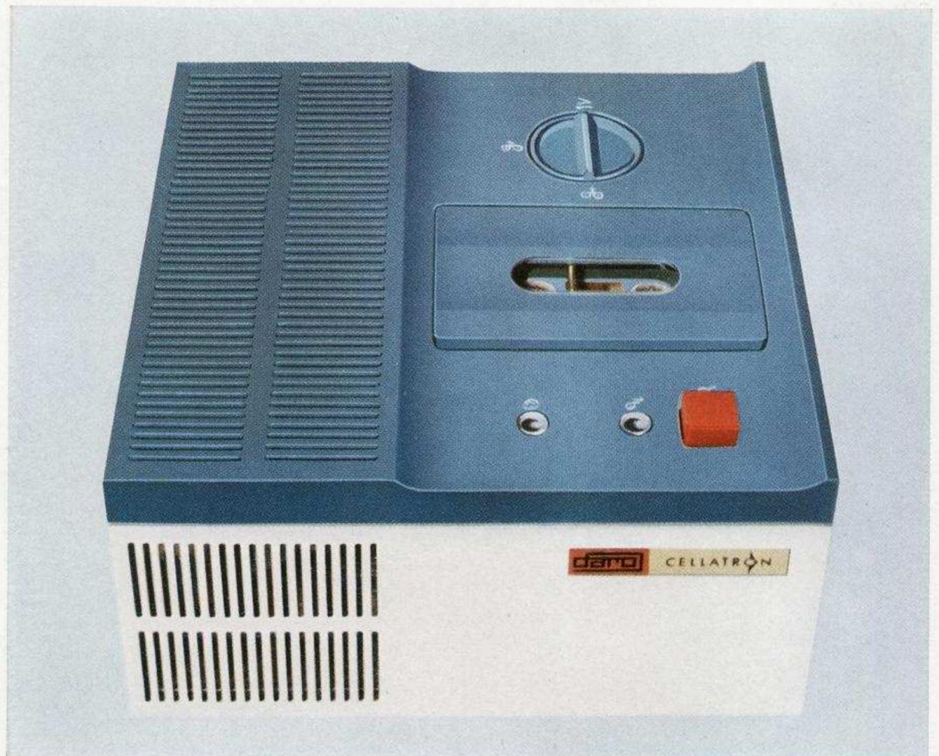
Das Gerät ist ein kombiniertes Aufzeichnungs- und Wiedergabegerät, das als externer Speicher genutzt wird. Die in digitaler Form vorliegenden Daten werden blockweise in 3 Spuren auf das Magnetband in der internationalen Normkassette K 60 aufgezeichnet bzw. gelesen.
