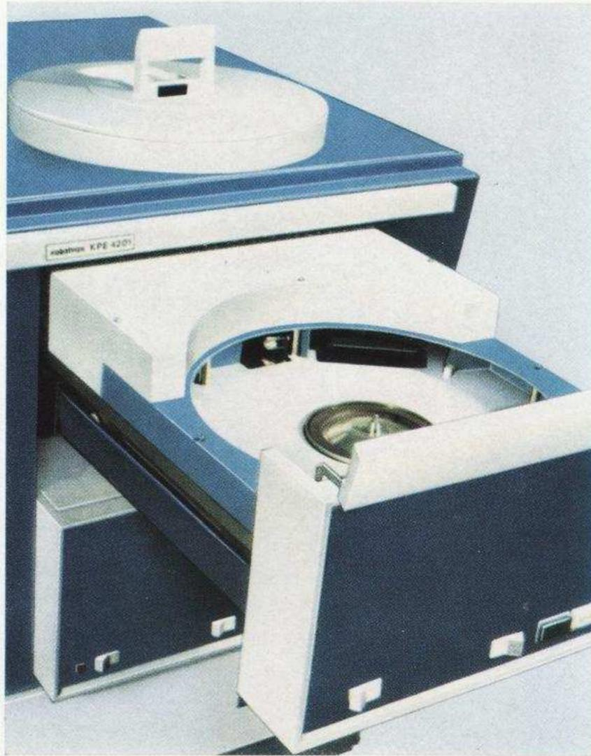
Im Kleinrechnersystem robotron 4201 sind Kassettenplattenspeicher einsetzbar. Maximal vier Kassettenplattenspeicher sind über eine Plattenspeichersteuerung im Rechner an den Externen Speicherkanal (ESK) des Rechners robotron 4201 anschließbar. Die Kassettenplattenspeicher können zur Daten- und Programmspeicherung genutzt werden.
