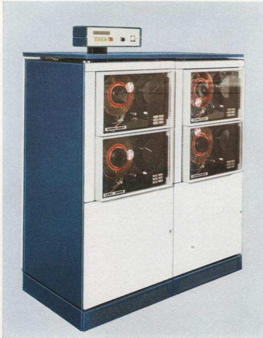
Das Magnetbandgerät ist ein externer Speicher, das mit dem Magnetbandsteuergerät zusammenarbeitet.
